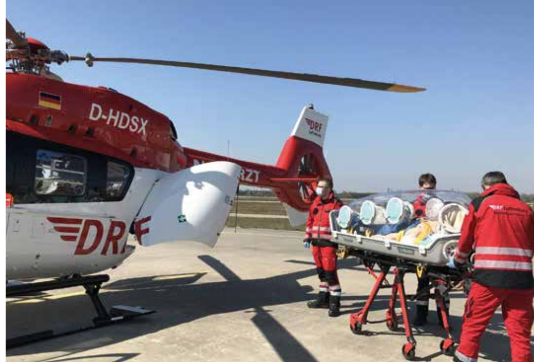
DRF-EpiShuttle zum Transport infektiöser Patienten / Quelle: DRF Luftrettung
